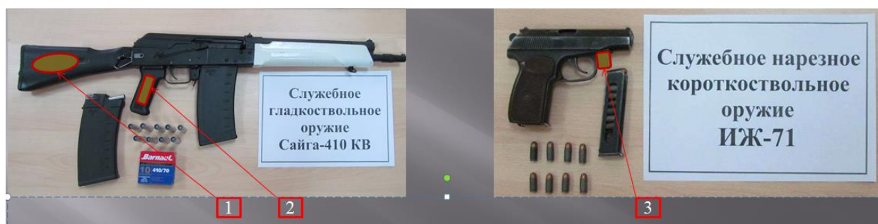
Рисунок 1. Размещение датчика-накопителя спутниковой навигации: 1 – в прикладе; 2 – в рукояти; 3 – на корпусе оружия.
